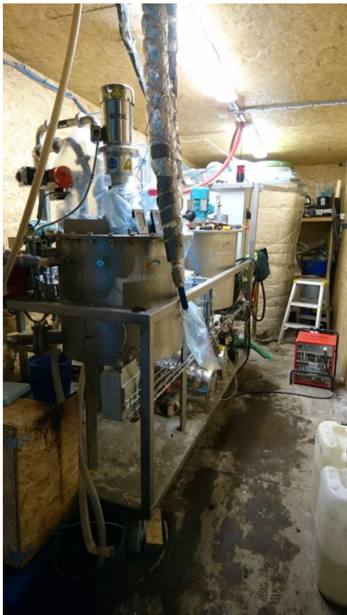
Figur 3. Pilotanläggningen som användes i pilotförsöken i mars 2018. I bilden till vänster finns kristallisatorn i förgrunden. Bilden till höger visar stripperkolonnen.
