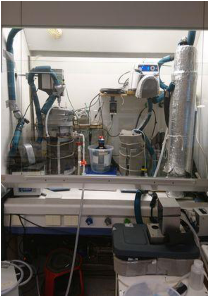
Figur 4. Bänkskalanläggningen med stripperkolonnen längst till höger och kristallisatorn till vänster med toppmonterad omrörare.
